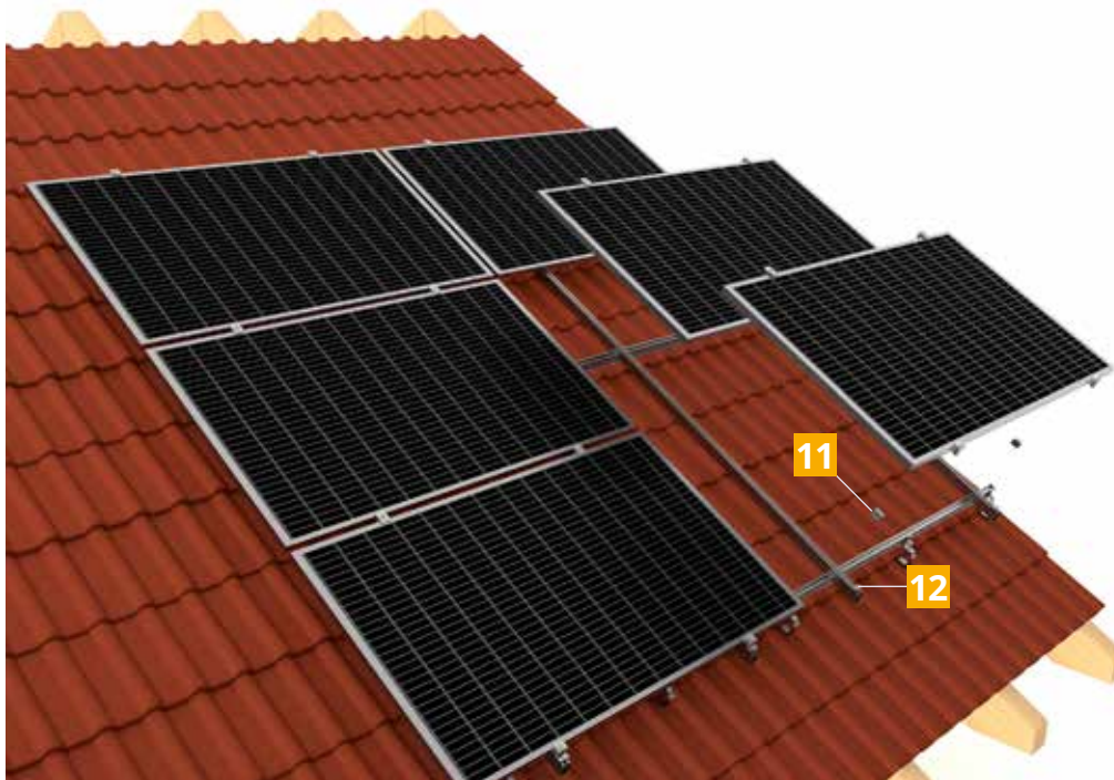
Kreuzverbinder zum Verbinden von zwei Trag- schienen im Kreuzverbund
